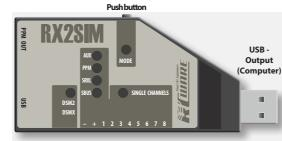
Spektrum<sup>®</sup> DSM2/DSMX remote satellite JR<sup>®</sup> DMSS
